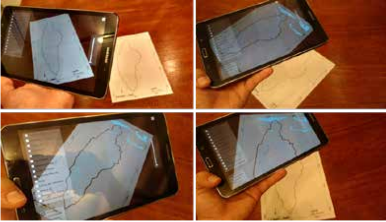
Figura 4 – Sistema de Realidade Aumentada com a apresentação de uma camada digital (layer de Recursos Hídricos) sobre o mapa impresso. (a) sem nenhuma camada sendo apresentada. (b-d) vários ângulos entre tablet e mapa impresso.
