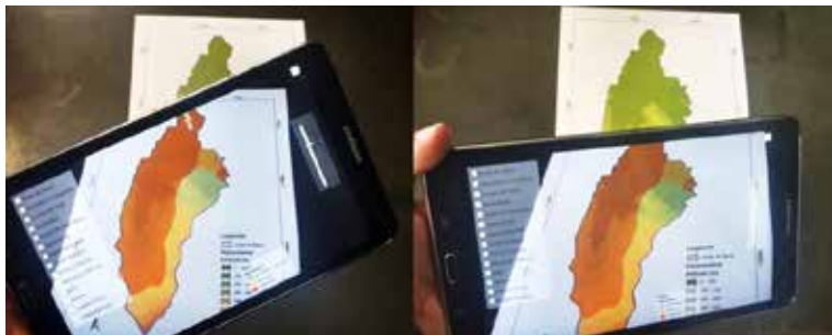
Figura 7 – Opção de transparência das camadas. Utilização do mapa impresso com informações hipsométricas e camada digital dos tipos de solo.
